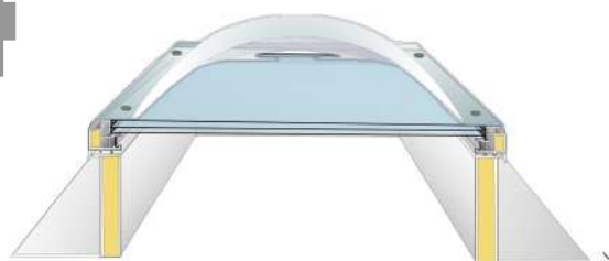
SVĚTLÍK S PLOCHÝM ZASKLENÍM A KOPULÍ
